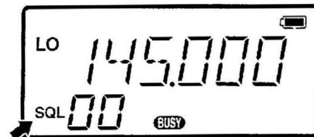
2. Benutzen Sie jetzt den Einstellknopf auf der Oberseite des Gerätes, um den gewünschten Schwellwert für die Rauschsperrschwelle einzustellen. Sie sollten einen Wert wählen, bei dem die Rauschsperrschwelle gerade geschlossen wird, denn je höher Sie die Rauschsperrschwelle setzen, desto stärker muß das empfangene Signal sein, um gehört zu werden.
