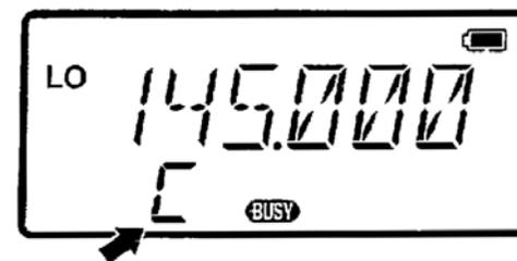
2. Um zwischen den beiden Anrufkanälen (VHF und UHF) zu wechseln, reicht ein kurzer Druck auf die "**D-Band/Name**"-Taste.
