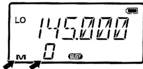
3. Um durch abgespeicherte Kanäle zu blättern, benutzen Sie einfach den **Einstellknopf** auf der Oberseite des Gerätes. Die Nummer des Speicherkanales wird unten links im Display angezeigt. Durch Drehen des **Einstellknopfes** in die entsprechende Richtung können Sie die Speicherkanal-Nummer verringern oder erhöhen (0-99).
