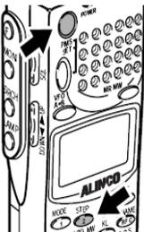
Schalten Sie das Gerät bei gedrückter STEP(2) Taste ein.
