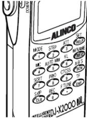
Drücken Sie die M NAME(RFC) Taste. Das RF CHECK Menü wird angezeigt. Positionieren Sie den Pfeil neben CHECKER, benutzen Sie hierzu den Einstellknopf, oder die UP/DOWN Taste, drücken Sie danach die TF(ENT) Taste.
