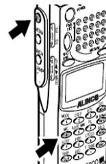
Drücken Sie die (F) Taste, während **F** angezeigt wird, drücken Sie die MIC(4) Taste. Die Aufnahme startet.
