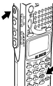
Drücken Sie die (F) Taste, während
