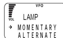
Nun wird das „CONFIG“ Menü angezeigt. Richten Sie den Pfeil auf „+LAMP“ und drücken dann die TF(ENT) Taste. Nun wird das „LAMP“ Menü angezeigt.
