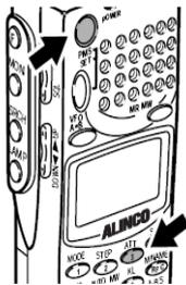
Schalten Sie das Gerät bei gedrückter ATT(3) Taste ein.
