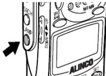
Drücken Sie die **LAMP** Taste. Während Sie nun den Einstellknopf oder eine Taste benutzen, bleibt die Display Anzeige beleuchtet. Wenn Sie eine Taste drücken oder gedrückt halten, wird diese ebenfalls beleuchtet. Die Beleuchtung schaltet automatisch ab, wenn 5 Sekunden keine Taste benutzt wurde.
