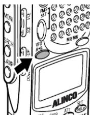
Drücken Sie die VFO A=B Taste. Dadurch wird der VFO Modus eingeschaltet. (Wenn der VFO Modus bereits eingeschaltet ist, können Sie durch drücken der Taste VFO A=B von Band A nach B umschalten).
