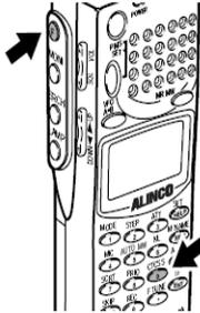
Drücken Sie die (F) Taste, während **F** angezeigt wird, drücken Sie die CTCSS(9) Taste. Das „CTCSS SET“ Menü wird angezeigt.
