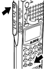
Drücken Sie die (F) Taste, während **F** angezeigt wird, drücken Sie die REC(0) Taste. Der Aufnahme Bildschirm wird angezeigt.
