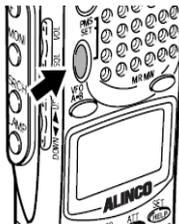
Drücken Sie die PMS SET Taste um in den PMS Modus zu gelangen. Wählen Sie ein registriertes Band und starten den Suchlauf. Ab Werk sind bereits Bänder registriert, diese können jedoch geändert werden. Siehe Kapitel 3.3.1 auf Seite 64.
