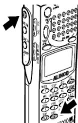
Drücken Sie die (F) Taste, während angezeigt wird, drücken Sie die REC(0) Taste. Der Aufnahme Bildschirm wird angezeigt.
