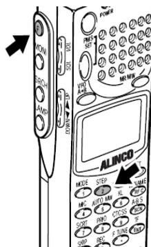
Drücken Sie die (F) Taste, während F angezeigt wird, drücken Sie die STEP(2) Taste. Danach wird das STEP Menü angezeigt. Nun positionieren Sie den Pfeil auf den gewünschte Frequenz Schritt, benutzen Sie hierzu den Einstellknopf oder die UP/DOWN Taste. Drücken Sie danach die TF(ENT) Taste.
