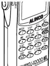
Drücken Sie die M NAME(RFC) Taste. Das RF CHECK Menü wird angezeigt. Positionieren Sie den Pfeil neben CALL WAIT und drücken danach die TF(ENT) Taste.
