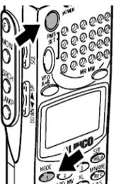
Schalten Sie das Gerät bei gedrückter MODE(1) Taste ein.
