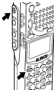
Drücken Sie die (F) Taste, nachdem **F** angezeigt wird, drücken Sie die MODE(1) Taste. Das MODE Menü wird angezeigt. Positionieren Sie den Pfeil an den gewünschten Frequenzbereich (Modulation), benutzen Sie den Einstellknopf oder die UP/DOWN Taste und drücken anschließend die TF(ENT) Taste.
