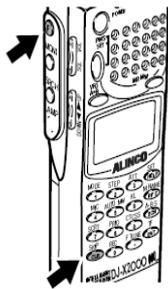
Drücken Sie die (F) Taste, während **F** angezeigt wird, drücken Sie die SKIP(CLR) Taste. Der „PASS EDIT“ Bildschirm wird angezeigt. Richten Sie den Pfeil auf eine gesperrte Frequenz, die Sie wieder aktivieren möchten, benutzen Sie den Einstellknopf oder die UP/DOWN Taste zum auswählen der Frequenzen. Zum aktivieren drücken Sie die REC(0) Taste. Die ausgewählten Frequenzen werden in der Anzeige gelöscht. Um den Vorgang zu beenden, drücken Sie die TF(ENT) Taste.
