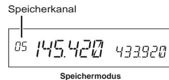
2. Wählen Sie einen Speicherkanal aus, indem Sie den Abstimmknopf drehen oder die U/D-Tasten am Mikrofon drücken. Jedes Drücken verändert den Speicherkanal um 1. Zum Aufruf eines Speicherkanales im Subband muß zuerst mit der Band-Taste das Hauptband umgeschaltet werden. Sobald sich die Subbandseite im Speicher- oder Anrufkanalmodus befindet, leuchtet das [★] - Symbol im Display auf.
