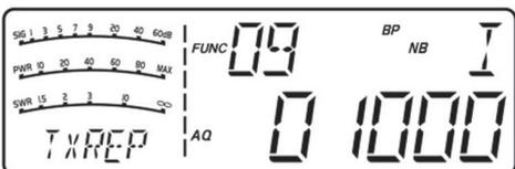
**Anzeigeformat:** XXXXX (entspricht XXXX,X kHz, der in obiger Abbildung eingestellte Wert ist 100,0 kHz)
