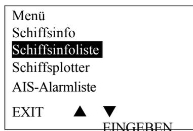
Im AIS-Schiffsinformationsmenü haben Sie drei Optionen: Listenmodus, Plottermodus, AIS-Alarmliste und Listenmodus. Wenn Sie die Option "AIS-Schiffsinfo-Liste" wählen und "Enter" drücken, wird der Listenmodus geöffnet.
