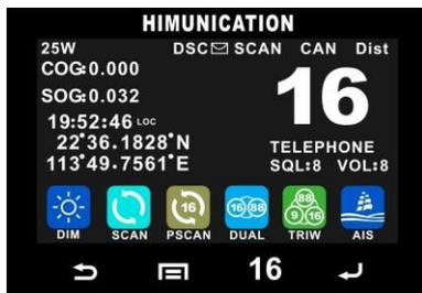
Klicken Sie auf "Start", um die Suchfunktion zu aktivieren, die nach allen derzeit funktionierenden Kanälen sucht. Alle Suchläufe: CH1-CH2-CH3-...-CH88. Speicherabfrage: M1 - M2 - M3 - ...M10 - M1- ...
