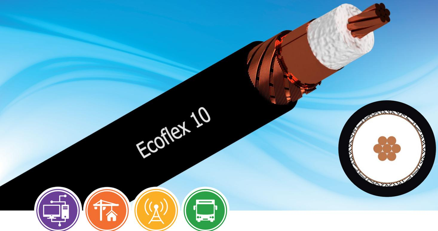
Ecoflex 10 ist ein flexibles und dabei sehr dämpfungsarmes 50 Ohm Koaxialkabel für den Frequenzbereich bis 6 GHz. Modernste Produktionsverfahren und die Verwendung eines verlustarmen PE-LLC-Dielektrikums mit einem Gasanteil von über 70 % ermöglichen geringe Dämpfungswerte, die bei flexiblen Koaxialkabeln dieser Dimension Maßstäbe setzen.
